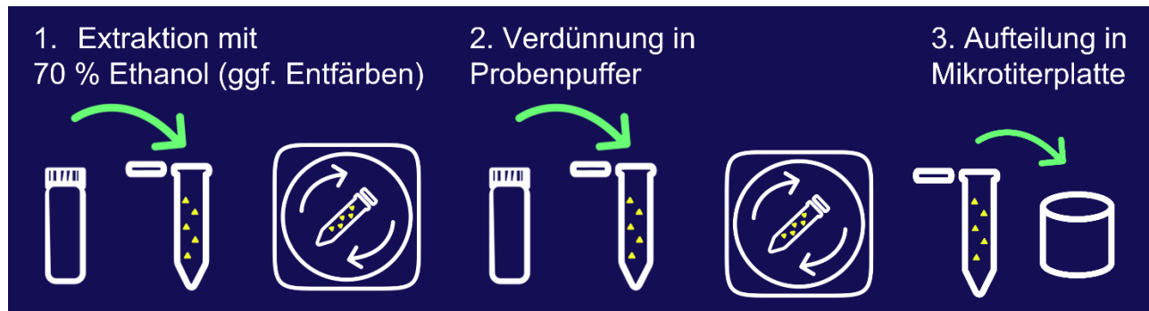
Abbildung 10 Übersicht über die Schritte der Probenvorbereitung
