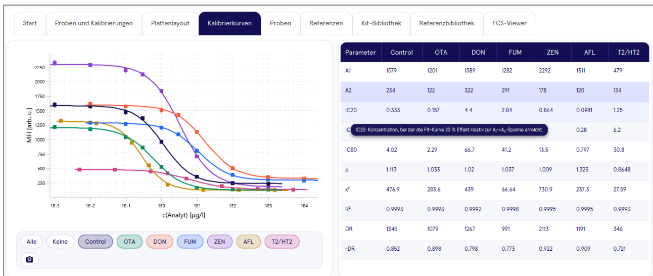
Abbildung 14. Übersicht über die Funktionen im Arbeitsbereich Kalibrierkurven
