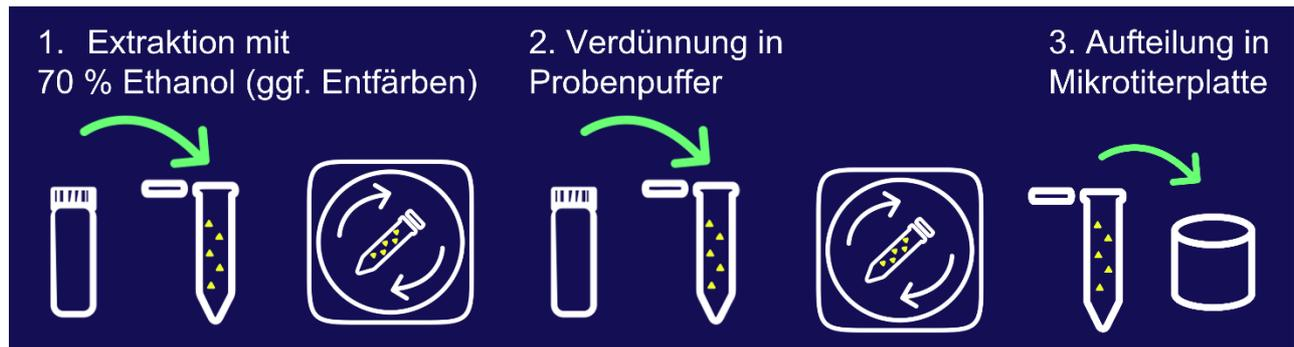
Abbildung 16. Übersicht über die Schritte der Probenvorbereitung
